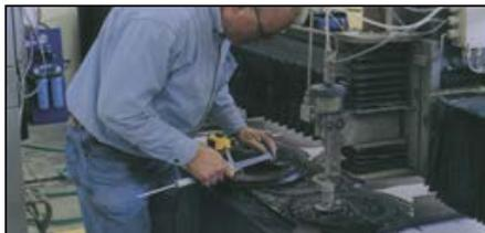
Corte mediante Chorro de Agua
