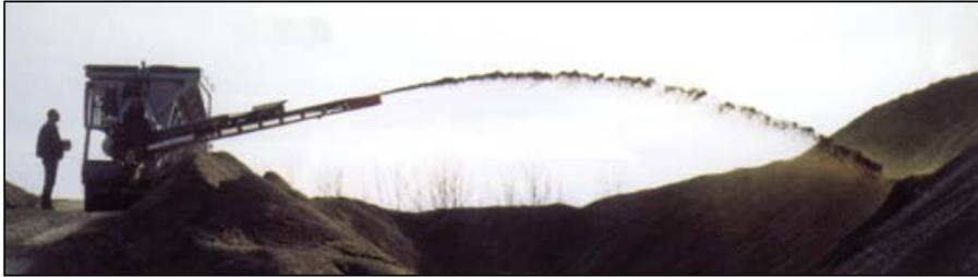
Estas bandas con empujadores tipo chevron vulcanizados plenamente a la unidad son diseñadas para virtualmente "lanzar" el producto transportado hacia áreas confinadas/ difíciles de alcanzar.
