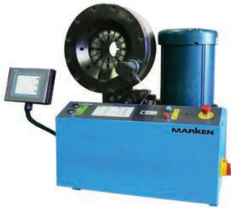
K60 Máquina Crimpadora hasta 4"
