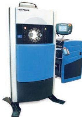
160UC Máquina Crimpadora hasta 6"
