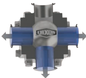
4-vías Puerto - 'T' posición A
