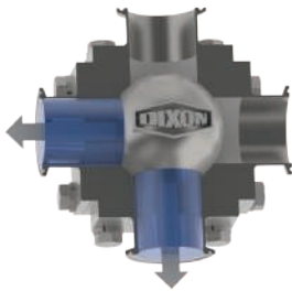
4-vías Puerto - 'L' posición A
