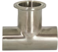
Tees de Flujo Soldables Pulidas x Ramificación tipo Clamp - B7WWM
