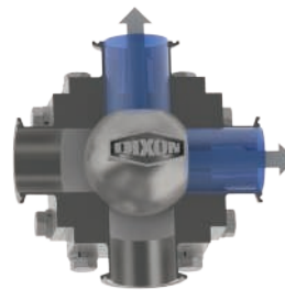
4-vías Puerto - 'L' posición C
