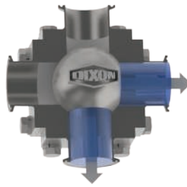
4-vías Puerto - 'L' posición B
