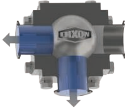
3-vías Puerto - 'L' posición A
